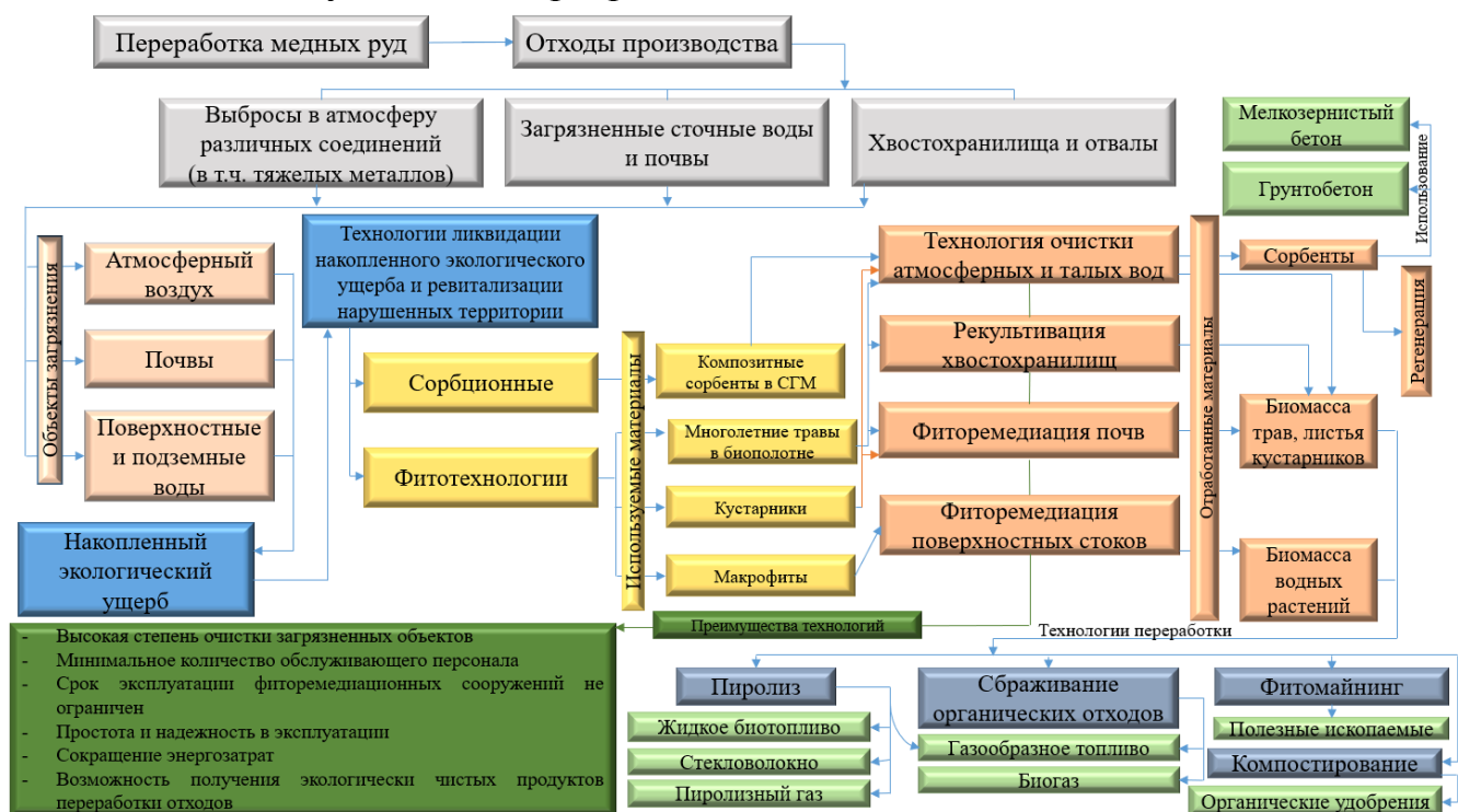
Рисунок 15 – Комплексная технологическая схема ликвидации накопленного ущерба
